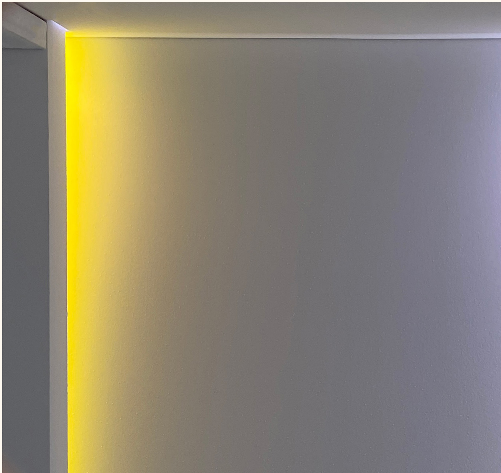
Bild 27: Fotografi av modell i skala 1:5, som visar en paus i innerväggen, där istället den yttre väggen blottas. Till vänster ser man ljuset stråla ut från den dolda belysningen.
