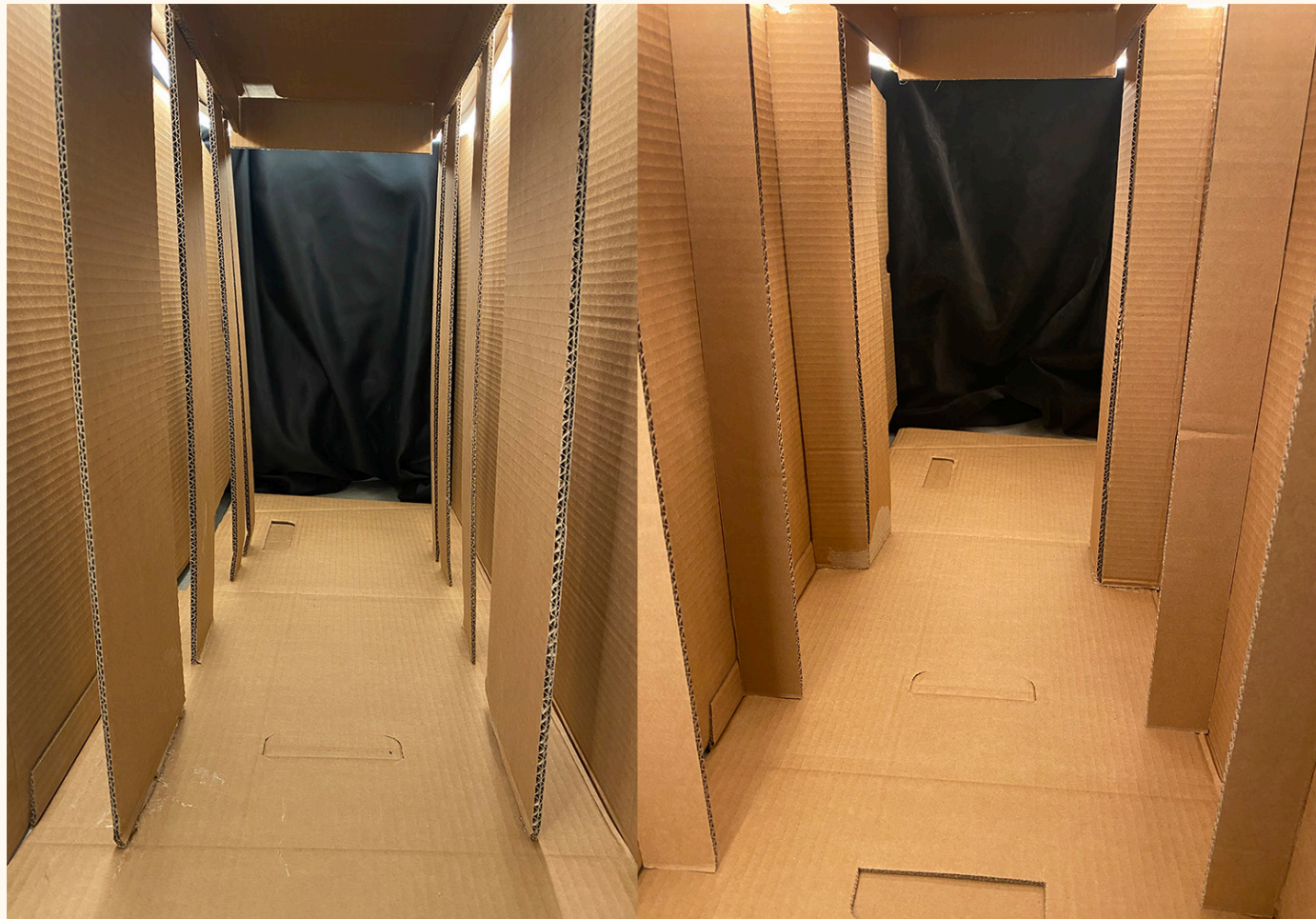
Bild 17: Modeller av flyttkartonger för att testa olika idéer kring väggarnas utformning och placering av ljuskälla. Dessa testade med en LED-list i taket.
